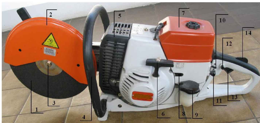
Fotografia nr 5.6. Budowa pily tarczowej
