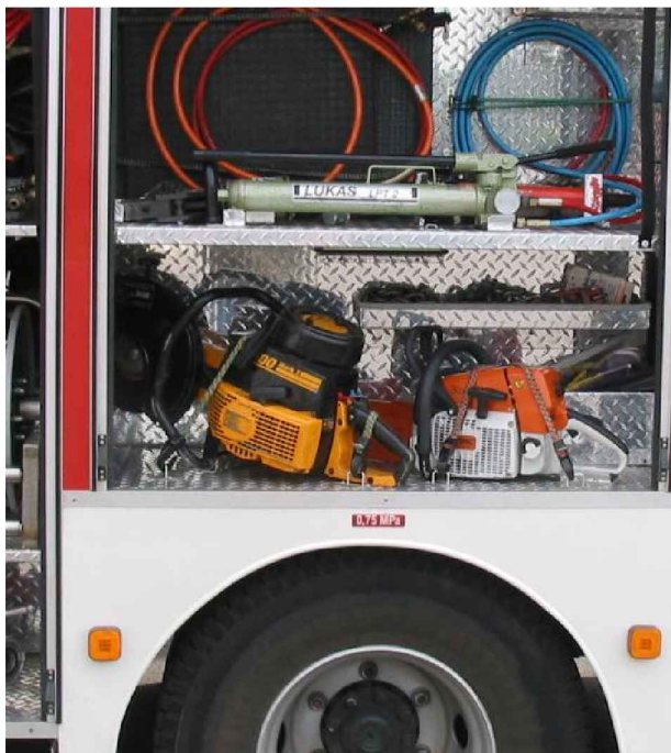
Fotografia nr 5.1. Rozmieszczenie sprzętu w skrytce pojazdu ratowniczego
