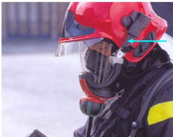
Fotografia nr 4.8. Mocowanie maski bezpośrednio do hełmu
