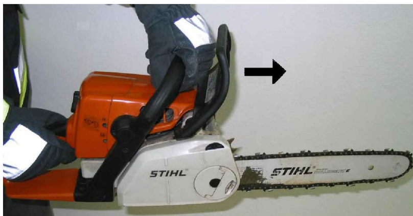
Fotografia nr 5.2. Uruchamianie hamulca łańcucha
