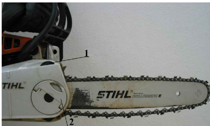
Fotografia nr 5.3. Niewłaściwe napięcie łańcucha tnącego
