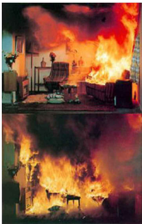
Fotografia 2.3. Rozgorzenie w pomieszczeniu 32
