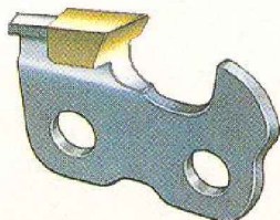
Rysunek nr 5.8. Ząb tnący z węglików spiekanych (widia) stosowany w łańcuchach pil stosowanych przez użytkowników profesjonalnych podczas akcji ratunkowych, prac rozbiórkowych oraz cięcia drewna zanieczyszczonego.
