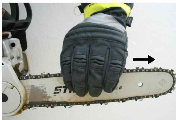
Fotografia nr 5.5. Sprawdzanie płynności ruchu łańcucha tnącego
