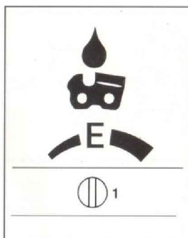
Rysunek nr 5.10. Przykładowe oznaczenie na korpusie pily śruby regulacyjnej wydajności pompy oleju
